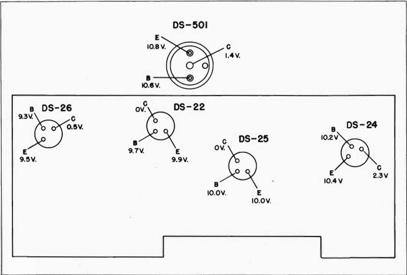
Figure 9 VOLTAGE CHART - ALL PUSH BUTTON - RADIOS
