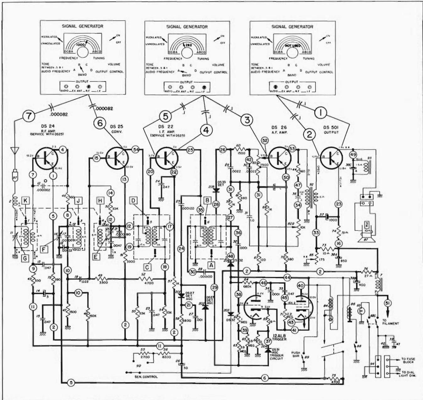
Figure 11 - SIGNAL TRACING PROCEDURE - 985396 - RADIO
