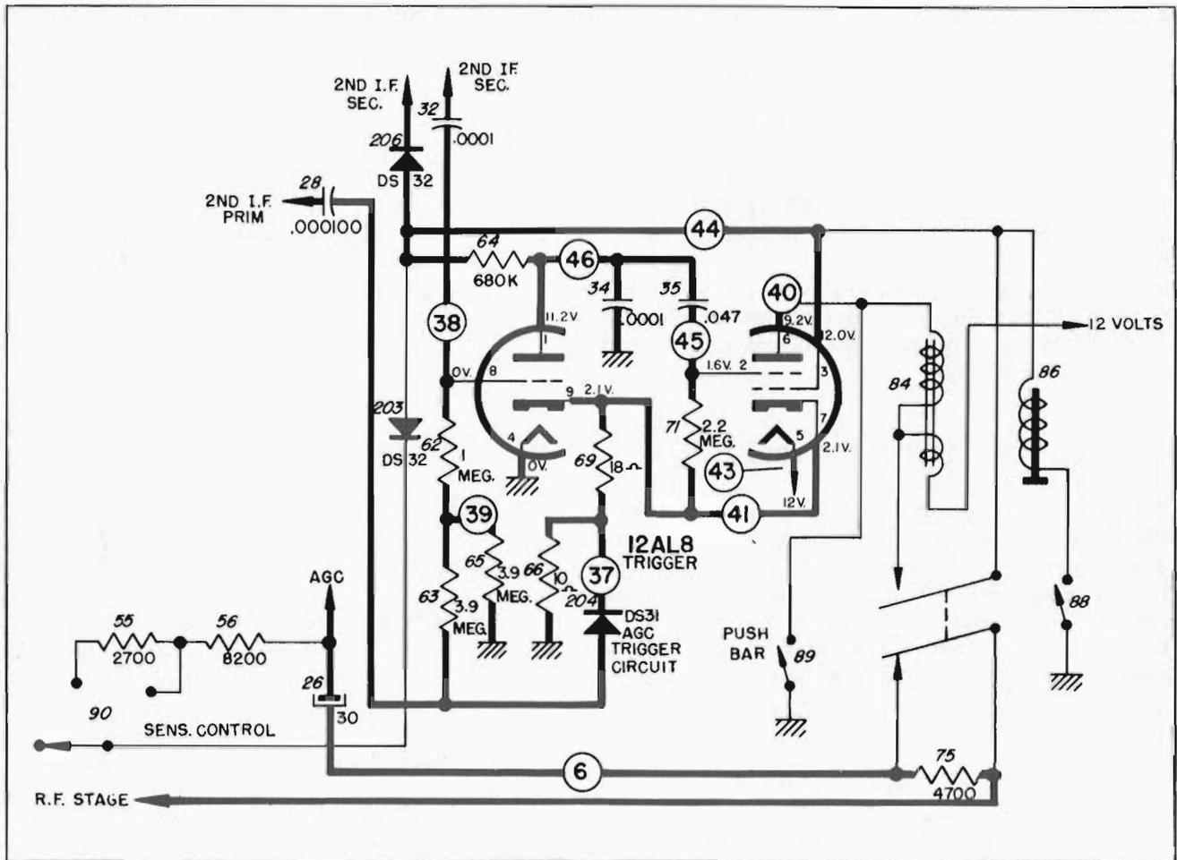
Figure 12 - TRIGGER CIRCUIT - 985396 - RADIO
