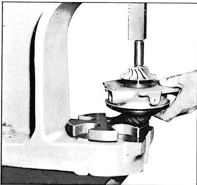
Fig. 35—Impeller Installation
