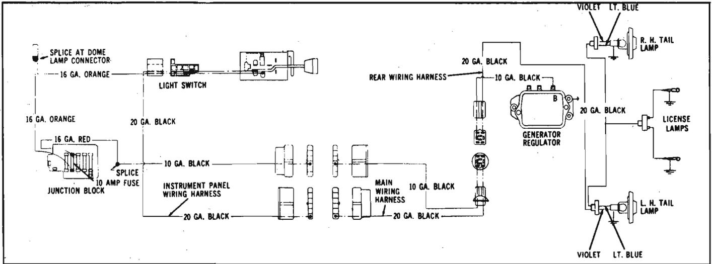
Fig. 8-156—Tail Lamp Circuit
