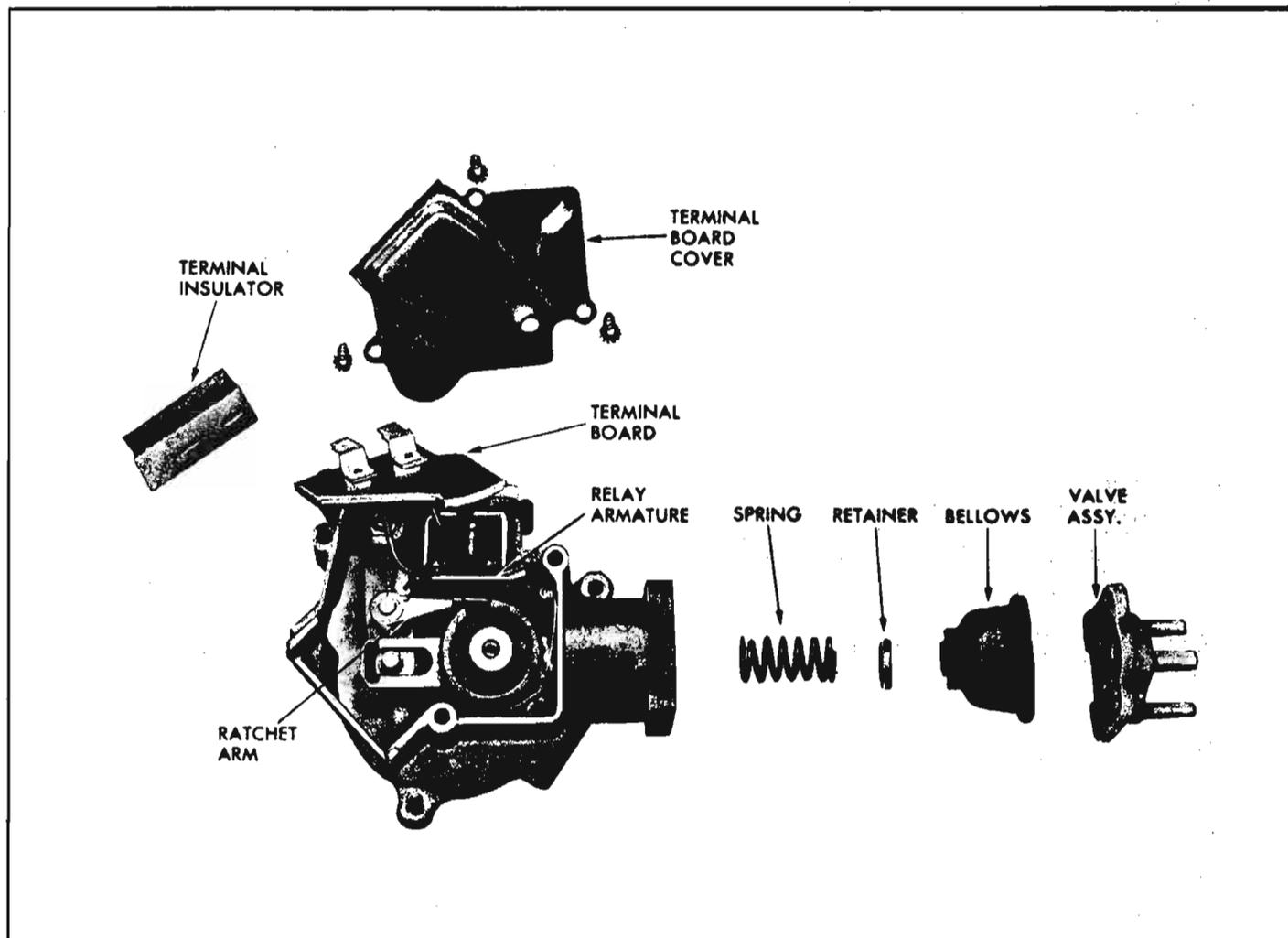
Fig. 8-142—Washer Pump Components
