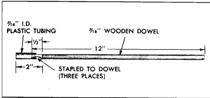
Fig. 8-62—Spark Plug Holding Tool
