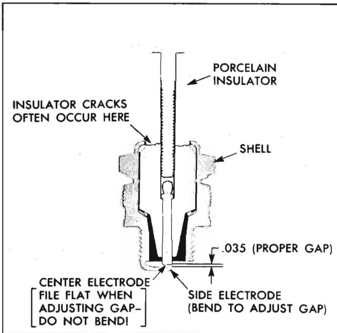
Fig. 8-63—Spark Plug Detail
