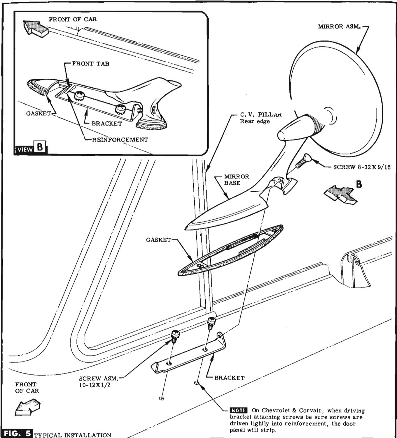
**FIG. 5** TYPICAL INSTALLATION
